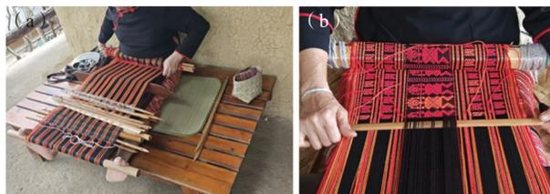
图1 黎锦制作过程 (a) 黎锦踞腰织机织造底布过程图; (b) 黎锦踞腰织机纺织图案过程图
