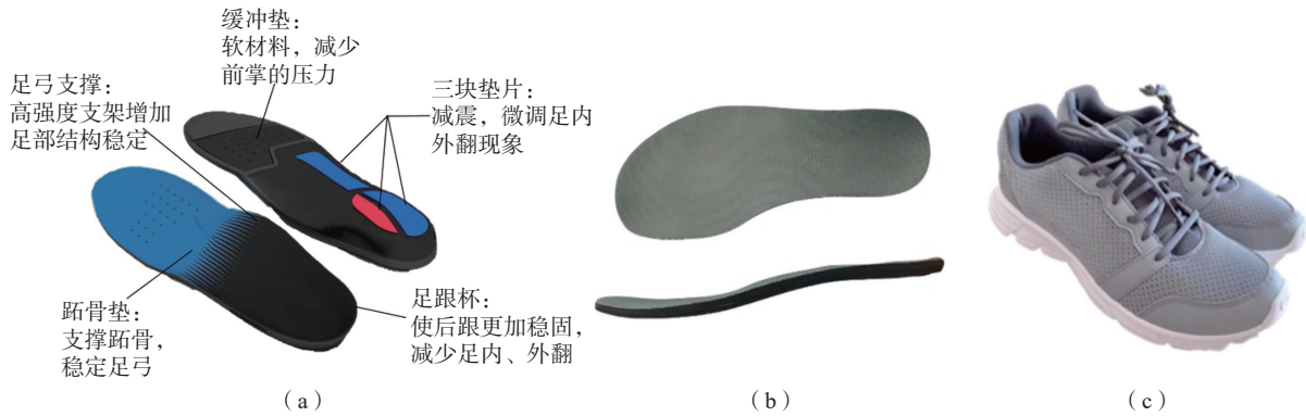
图1 实验用鞋及鞋垫 (a) 矫形鞋垫, (b) 平鞋垫和 (c) 实验跑鞋
